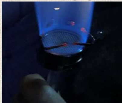
Каталитическое окисление газа
